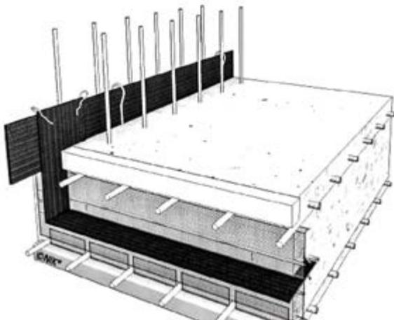
Abschalelement zur Ausbildung rauer und verzahnter Arbeitsfugen nach DIN EN 1992-1-1/NA in Bodenplatten, Decken und Wänden. Die Abdichtung erfolgt durch bauseits einzubringendes CEMflex® VB, AVS-JGS oder AVS-LAU.
