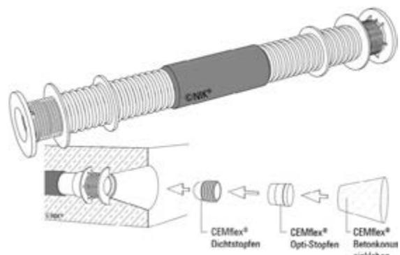
Beschichtete Mauerstärke zur Ausbildung flüssigkeitsundurchlässiger Spannstellen. Ausführungen für CEMflex® AVS-JGS und AVS-LAU. Rückversetzte Ausführung zum Schutz vor Angriff durch die Belastungsmedien und gleichzeitig vor mechanischer Beschädigung. Verschluß durch Dicht- und Optistopfen und das Einkleben eines Baustopfens.
