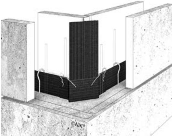
Element zur Ausbildung von Sollrissfugen in Elementwänden. Die Fugenabdichtung erfolgt mit integriertem Fugendichtblech CEMflex® VB. Verwendbar nach abP bis zu einem Wasserdruck von 4 Metern.
