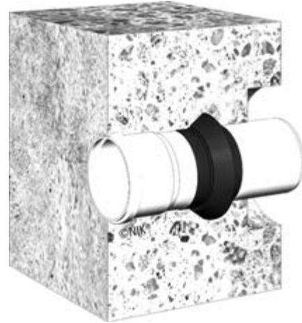
Flüssigkeitsundurchlässige Bauteildurchdringungen aus HD-PE mit Dichtkragen und Beschichtung aus CEMflex® VB, AVS-JGS oder AVS-LAU. Ausführung als Futterrohr, Transwand, Doppelmuffe oder Wanddurchführung.
