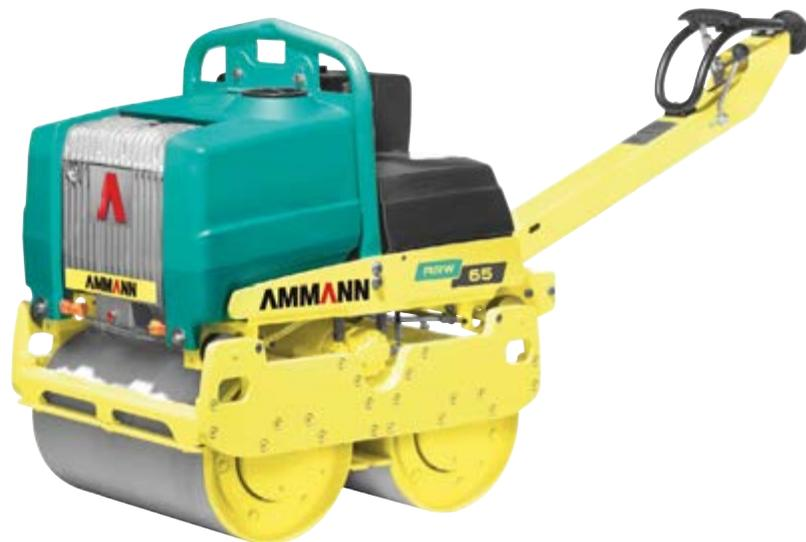
**Ammann handgeführte Vibrationswalze**
