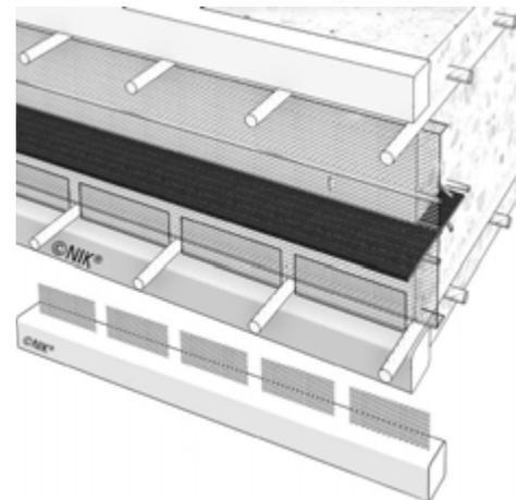
Element aus Faserbeton und Streckmetall zur Abschaltung der Bewehrungszwischenräume, Erzielung einwandfreier Fugengeometrien und Verhinderung des Austretens von Feinanteilen im Bereich der Arbeitsfuge. Die Betondeckung und das Raster der unteren Bewehrung werden eingehalten.
