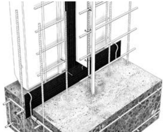
Element zur Ausbildung und gleichzeitigen Abdichtung von Sollrissfugen in Ortbetonwänden. Die Fugenabdichtung erfolgt mit integriertem Fugendichtblech CEMflex® VB. Verwendbar nach abP bis zu einem Wasserdruck von 4 Metern.
