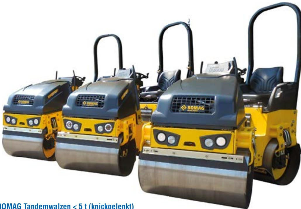
**BOMAG Tandemwalzen < 5 t (knickgelenkt)**
