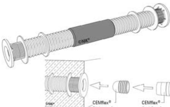
Beschichtete Mauerstärke zur Ausbildung wasserundurchlässiger Spannstellen. Einfach und sicherer Verschluß mit Dicht- und Optistopfen.
