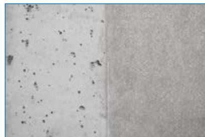
Links ohne Zemdrain®, rechts mit Zemdrain®.
