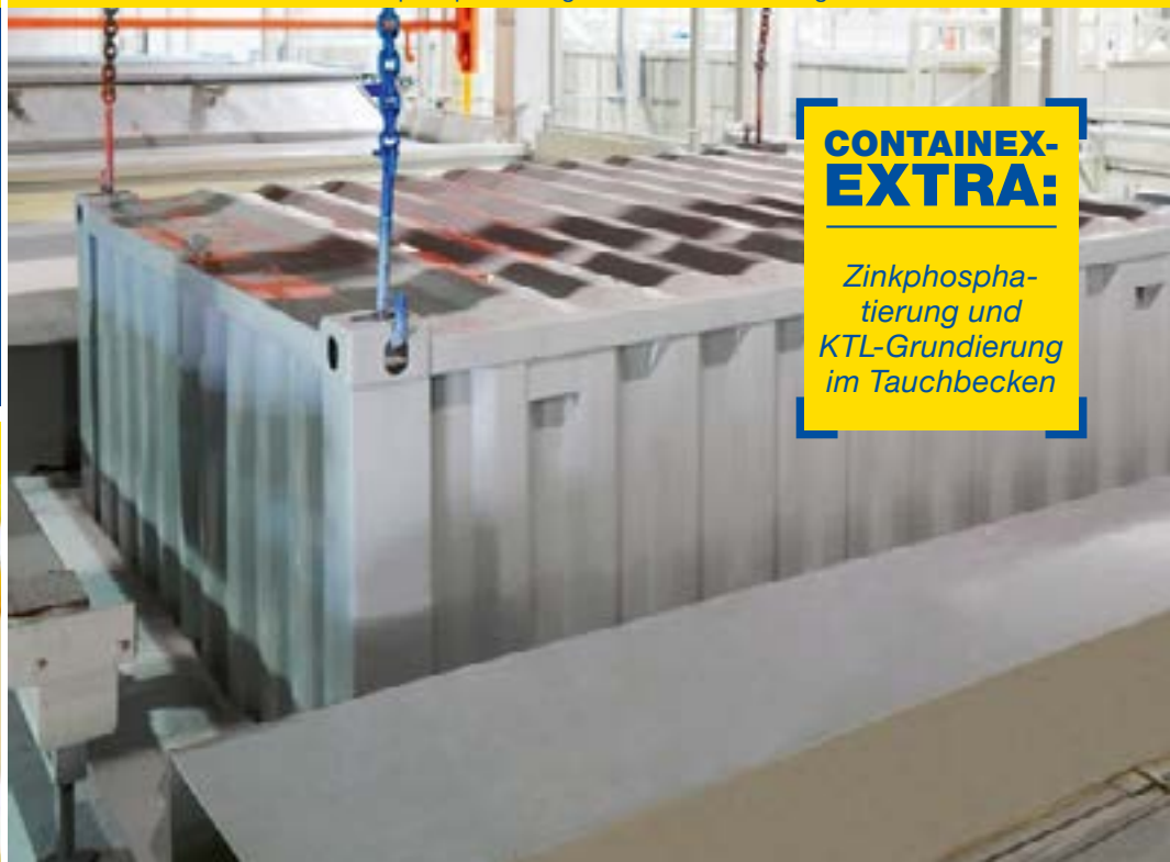
Zinkphosphatierung und KTL-Grundierung
